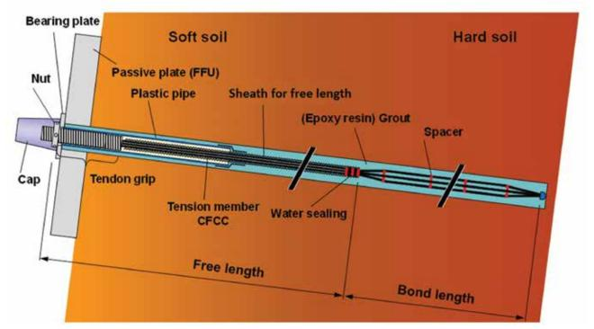
Fig. 14—Ground Anchor System.
